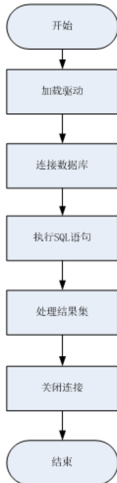
图 6-4 采用 Psycopg2 开发应用程序的流程
